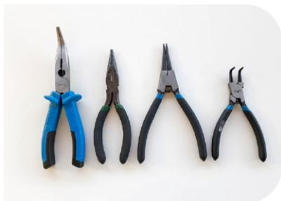
Alicate de bico: meia-cana, curvo, bico redondo e para retirar trava
