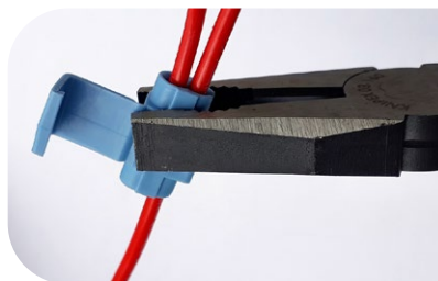
Prese com um alicate a trava metálica contra os fios
