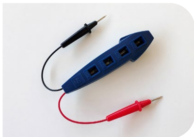
Equipamento de teste de contato e LEDs indicadores, sem bateria
