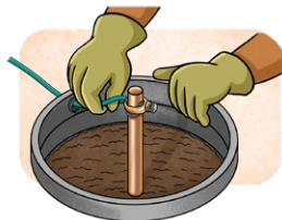
Fio terra da instalação ligado à haste de aterramento
