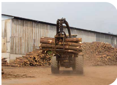
Trator agrícola adaptado com caçamba ou guincho
