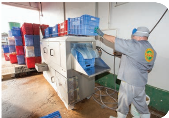
Máquina para limpeza e desinfecção de caixas plásticas em indústria de polpas de frutas
