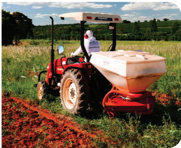
Trator com distribuidor de adubos e calcário
