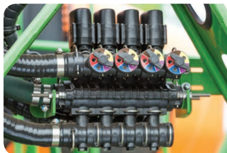
4. Conjunto de atuadores (válvulas) de seções
