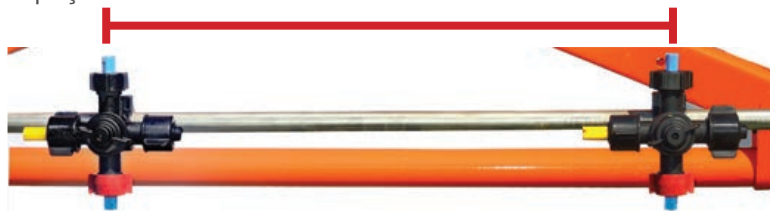
Faixa de aplicação – espaçamento entre bicos
