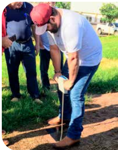
Penetrômetro hidráulico, no detalhe, haste do penetrômetro e penetrômetro manual eletrônico
