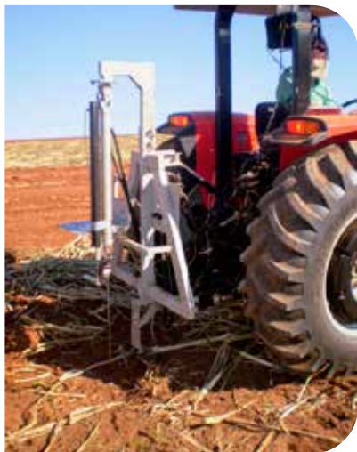
Penetrômetro hidráulico, no detalhe, haste do penetrômetro e penetrômetro manual eletrônico
