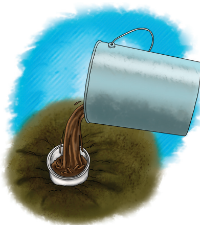
Coloque a mistura de água e esterco na válvula de retenção
