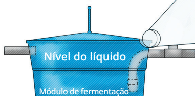
Esquema de vedação das caixas de fermentação
