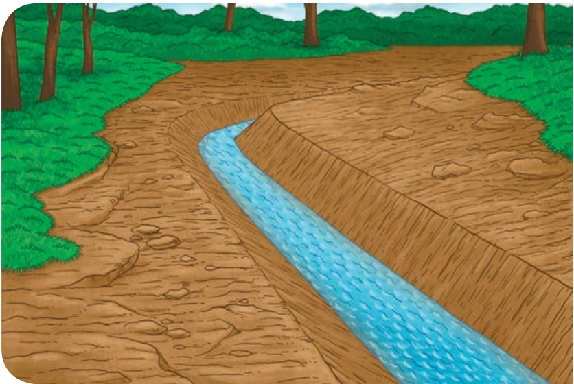
Canal escavado em formato trapezoidal, sem revestimento
