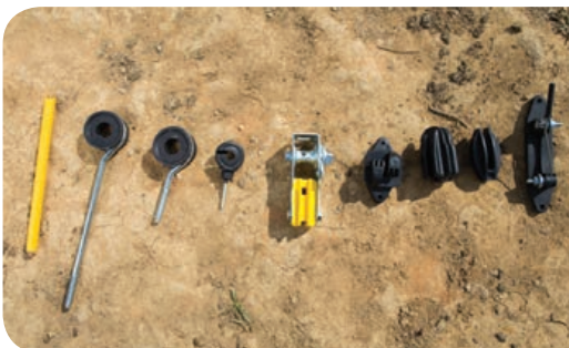
tubo isolado, isoladores e chave interruptora
