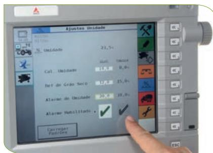
Além das informações da umidade real e da umidade informada pelo sensor da colhedora, é necessário que o operador estabeleça o nível de umidade máxima e de grão seco (mínima).
